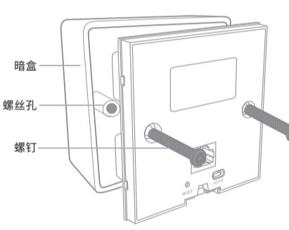
4 根据图示方向固定壳盖，完成安装
