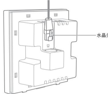
3 对准AP与暗盒上的螺丝孔，装入2个螺钉固定，请勿将螺钉拧得过紧
