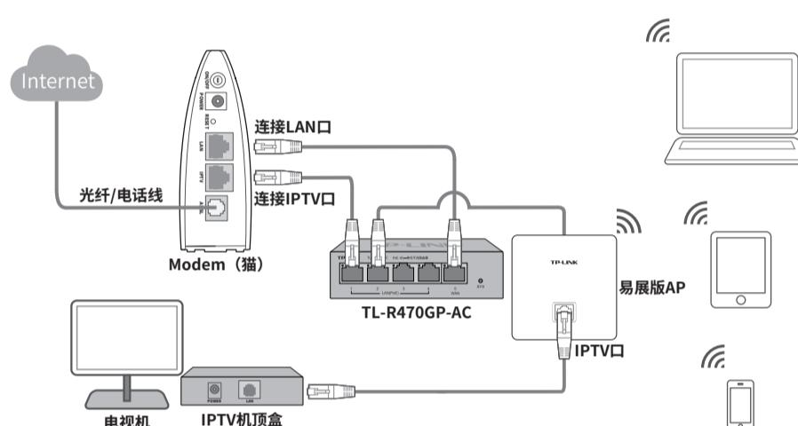
3 按照如上步骤和示意图将设备连接完好之后,将易展AP的FAT/FIT模式开关拨到FIT模式(如下图所示),并确认AP已正常上电。
